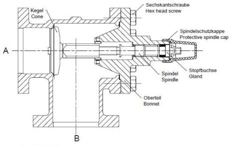
Spindel geöffnet Spindle position open
